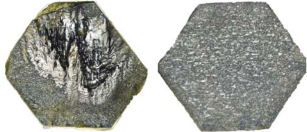
Abbildung 13: Geschnittene SDB 1125 Diamantkörner mit Grösse D426; links: Thermische Schädigung an der Freifläche aufgrund Überschreitens der maximalen Schnitttiefe; rechts: Schnittergebnis mit optimierten Prozessparametern.
